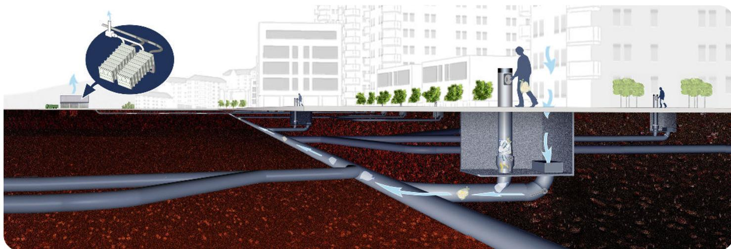
I en sopsug transporteras soporna med hjälp av luft i ett rörsystem under marken. Det enda du ser av systemet är sopnedkastet.
